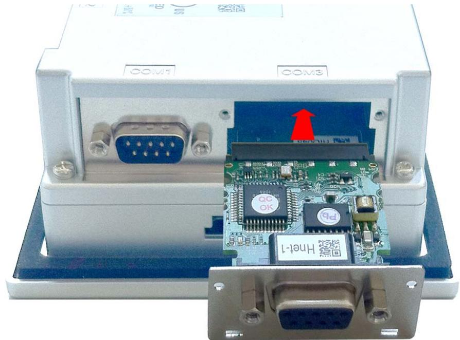
2. ➤ Führen Sie das zu montierende Schnittstellenmodul durch den Schacht ein. Schieben Sie das Schnittstellenmodul in das Gerät, bis das Halteblech am Gehäuse anliegt. Hierbei wird das Schnittstellenmodul durch die 2 innen liegenden Führungsleisten aufgenommen und in die richtige Position gebracht.
