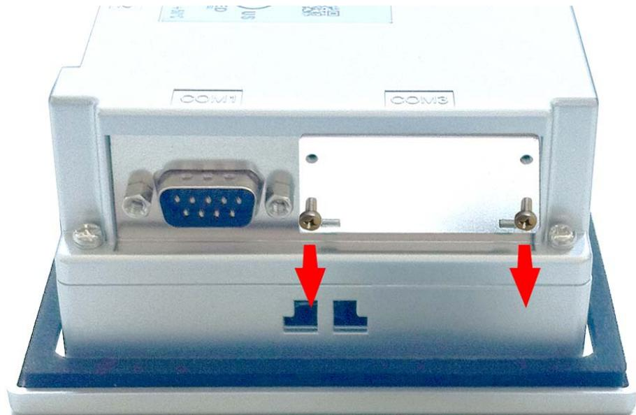
1. Entfernen Sie das Abdeckblech der COM3-Schnittstelle, indem Sie die Schrauben entfernen und das Blech abziehen.
