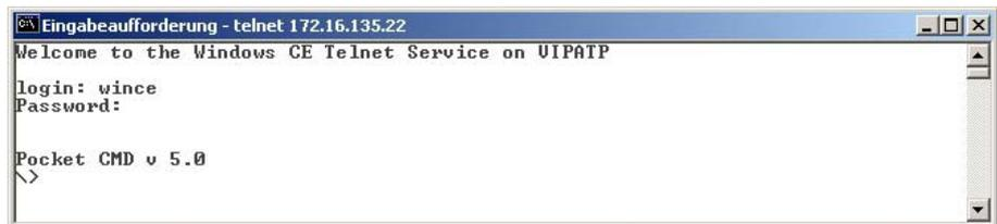
Durch Eingabe von `Exit` bzw. indem Sie das Fenster schließen, können Sie jederzeit eine Telnet-Verbindung wieder beenden.
