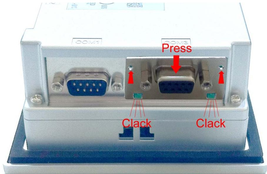
3. ➤ Drücken Sie jetzt das Schnittstellenmodul leicht nach unten, bis das Halteblech an den Haltenasen einrastet.
