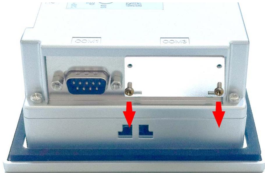
1. Entfern Sie das Abdeckblech der COM3-Schnittstelle, indem Sie die Schrauben entfernen und das Blech abziehen.
