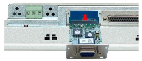
2. Führen Sie das zu montierende Schnittstellenmodul durch den Schacht ein. Schieben Sie das Schnittstellenmodul in das Gerät, bis das Halteblech am Gehäuse anliegt. Hierbei wird das Schnittstellenmodul durch die 2 innen liegenden Führungsleisten aufgenommen und in die richtige Position gebracht.
