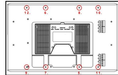
5. Die VESA Bohrlöcher sind bei Auslieferung mit Lamellenstopfen versehen. Vor Verwendung der VESA Montageoption sind diese entsprechend zu entfernen. Nicht verwendete VESA Bohrlöcher sind mit Lamellenstopfen geschlossen zu halten.
