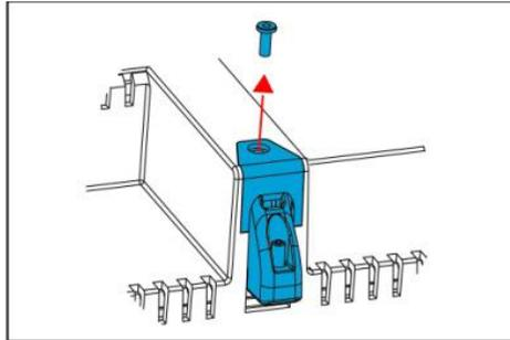
2. Schrauben Sie die beigestellten Gewindebolzen (M3x30 I/A) von Hand in jedes Quick-Snap Element.
