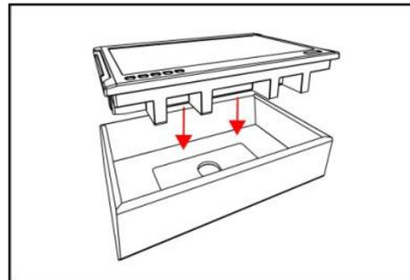
4. Montieren Sie das Gerät mit einem Schraubendreher (Tx10) am Umgehäuse. Verwenden sie dazu die beigestellten Schrauben (M3x8) und ziehen diese handfest an. Beachten Sie dabei die Reihenfolge der Verschraubung.
